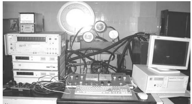
Рисунок 9 – Стендовое оборудование ПО «МТЗ» для испытаний и мониторинга КПД и технического состояния гидроприводов при их проектировании, модернизации и доводке
