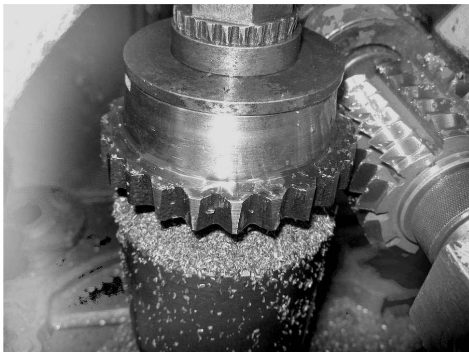
Рисунок 3.6 – Процесс обработки зубьев сателлита на зубофрезерном станке модели 5310, получаемых способом конического зубофрезерования
