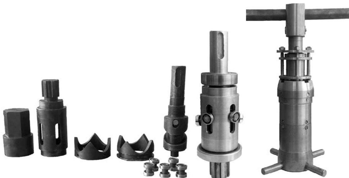
Рисунок 5.27 – Ключ для демонтажа и сборки резьбовых соединений (основные детали, сепаратор в сборе с телами качения, ключ)
