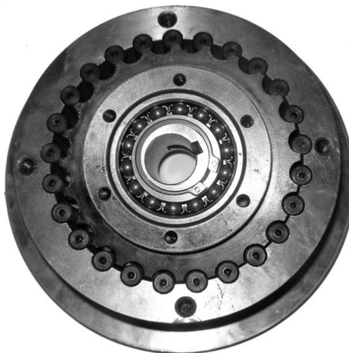
Рисунок 5.22 – Общий вид деталей прецессионного редуктора с роликами в качестве центрального колеса
