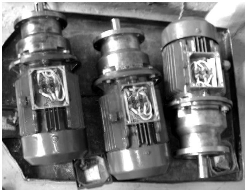
Рисунок 5.12 – Экспериментальные образцы прецессионных мотор-редукторов
