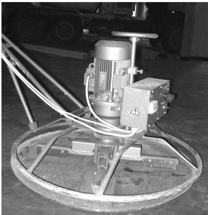
Рисунок 5.19 – Заглаживающая машина СО-170 с прецессионным мотор-редуктором
