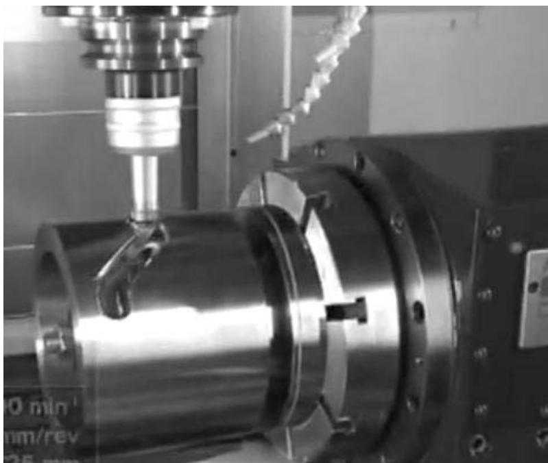
Рисунок 4.7 – Реализация кинематического метода на вертикально-фрезерном обрабатывающем центре серии NVX 5100
