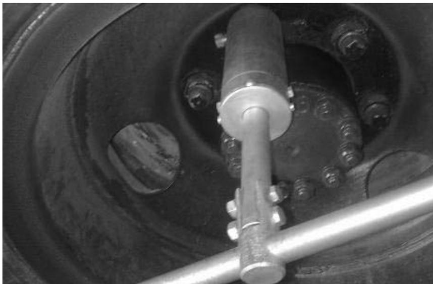
Рисунок 5.24 – Общий вид ключа для демонтажа ведущих колес грузовых автомобилей ЗИЛ и ГАЗ
