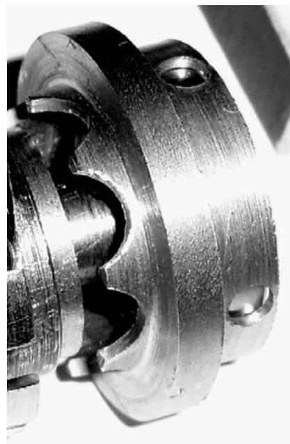
Рисунок 4.11 – Наружные кулачки с упрощенной формой беговых дорожек
