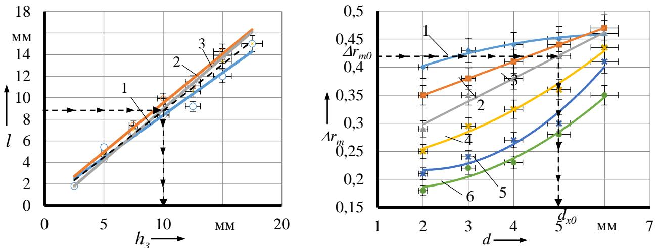
a) 1 – диаметр дефекта  $d = 2$  мм; 2 –  $d = 4$  мм; 3 –  $d = 6$  мм; - - - средняя линия;
