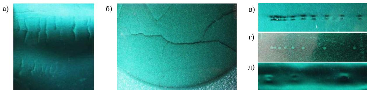
**Рисунок 1 – Индикаторные рисунки трещин: в сварном шве (а), в плоском образце (б); компактных дефектов: поверхностных (в, г), внутренних (д)**
