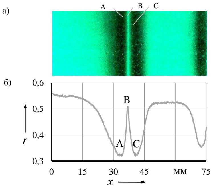
**Рисунок 3 – Изображение индикаторного рисунка дефекта (а) и соответствующей ему зависимости распределения коэффициента диффузного отражения света от пленки (б) от расстояния поперек плоского дефекта внутренней поверхности пластины: ширина дефекта – 1,5 мм, глубина – 3 мм**
