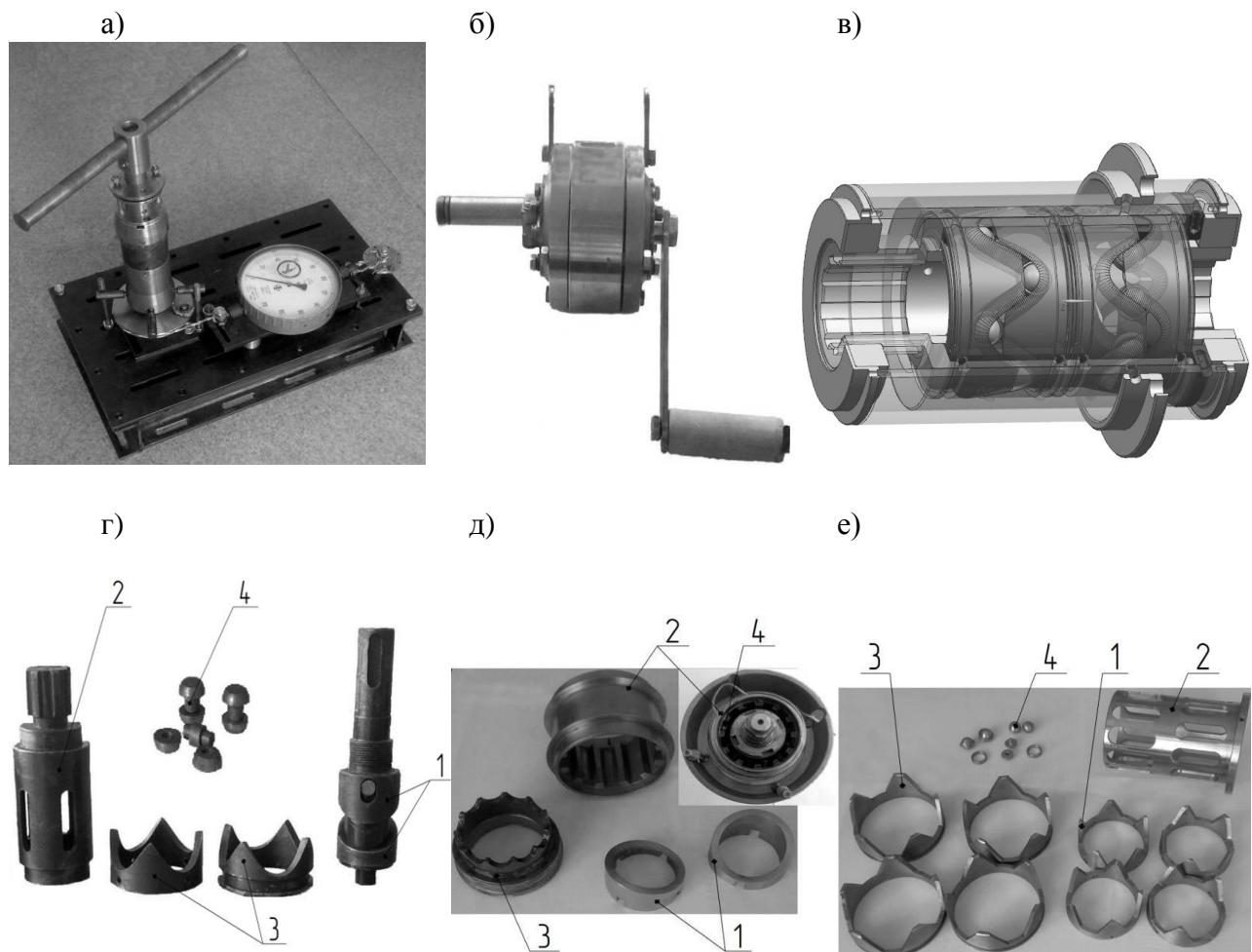
1, 3 – кулачки; 2 – ведомый вал (сепаратор); 4 – составные ролики
