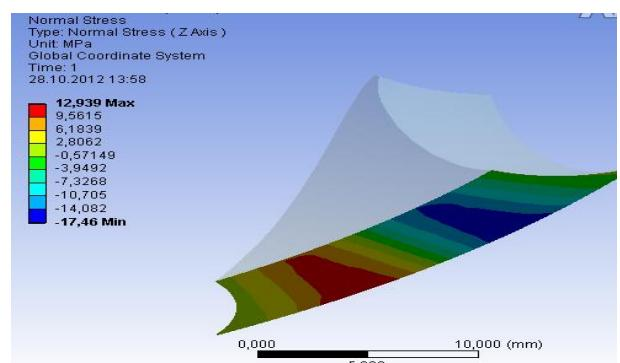
**Рисунок 8 – Нормальные напряжения, действующие в опасном сечении выступа кулачка, закрепленного в корпусе**
