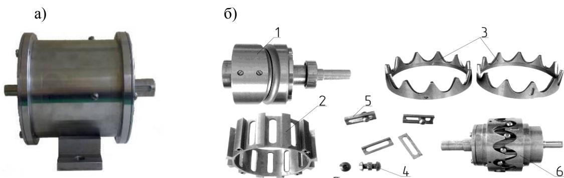
1 – кулачки на ведущем валу; 2 – ведомый вал; 3 – кулачки, закрепляемые в корпусе;
