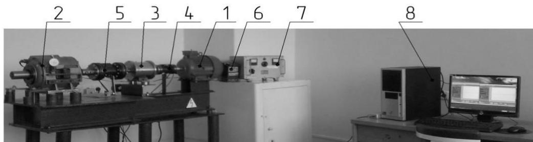
1 – асинхронный электродвигатель; 2 – порошковый тормоз; 3 – испытываемый редуктор;
