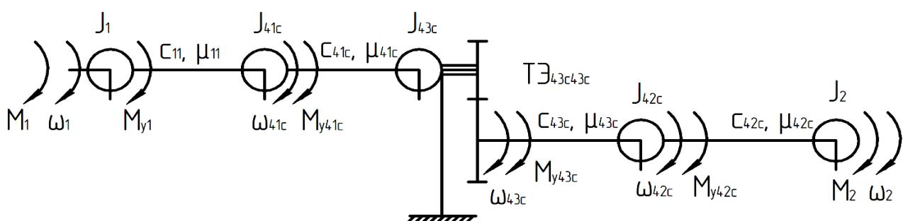
1 – кулачки, закрепленные на ведущем валу; 41с – звено, состоящее из втулок полусферической формы; 43с – звено, состоящее из ступенчатых роликов; 42с – звено, состоящее из втулок цилиндрической формы; 2 – ведомый вал
