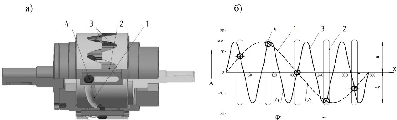
Рисунок 1 – Конструкция ЦКРП (а) и модель взаимодействия тел качения с основными звеньями зацепления (развертка на плоскость) (б)
