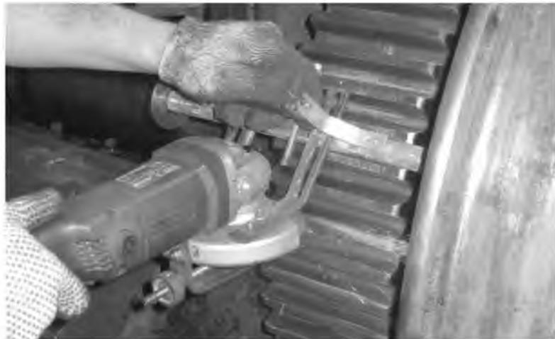
**Рисунок 8 – Корректировка профилей зубьев ведомого зубчатого колеса КМБ локомотива ЧМЭ3**
