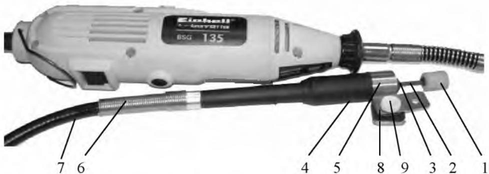
1 – шлифовальная головка; 2 – хвостовик; 3 – зажим; 4 – втулка; 5 – хомут; 6 – броня; 7 – гибкий вал; 8 – звено базирования; 9 – винт
