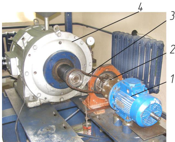
1 – приводной электродвигатель; 2 – испытываемый прецессионный редуцирующий механизм; 3 – цепная передача; 4 – порошковый тормоз
