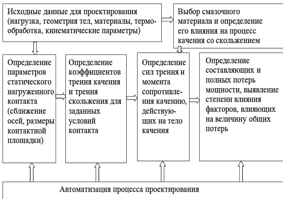
Рисунок 1.37 – Алгоритм определения потерь мощности в передачах и механизмах с телами качения
