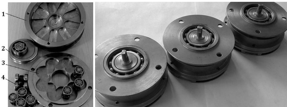
Рисунок 7.8 – Редуцирующие узлы на базе ППТК плоского типа
