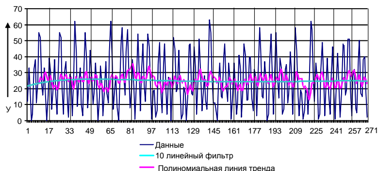
Рисунок 8 – График погрешности угла поворота выходного вала модели № 2 планетарной плавнорегулируемой передачи
