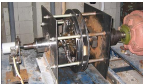
Рисунок 5 – Планетарная плавнорегулируемая передача на стенде
