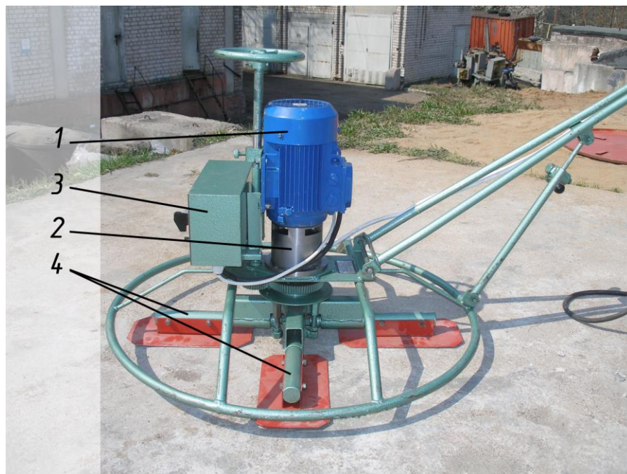
Рис.10. Бетонозаглаживающая машина СО-170 с мотор-редуктором на базе планетарной прецессионной передачи типа К-Н-V: 1 – электродвигатель, 2 – прецессионный редуктор, 3 – электрооборудование, 4 – рабочий орган
