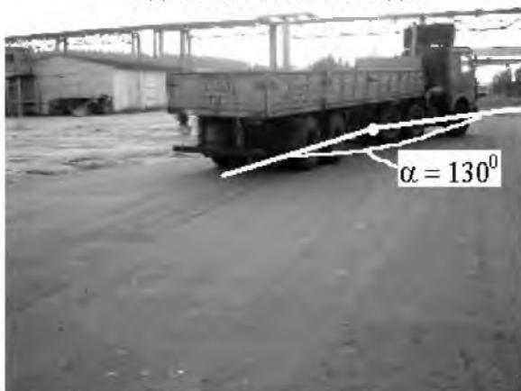
**Рисунок 14 – Положение звеньев автопоезда в конце торможения**
