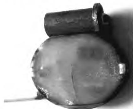
**Рисунок 11 – Датчик измерения сил в опоре колодок тормоза**
