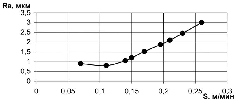
**Рисунок 5 – Зависимость шероховатости от подачи инструмента для бронзовых втулок диаметром 23 мм при давлении 0,2 МПа и диаметре шаров 5,6 мм с твердостью 110...115 НВ, исходной шероховатостью  $Ra_{исх}$  4,7...5 мкм**
