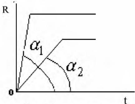
Рисунок 10 – Схематичное представление изменения сил в опоре подвески сиденья
