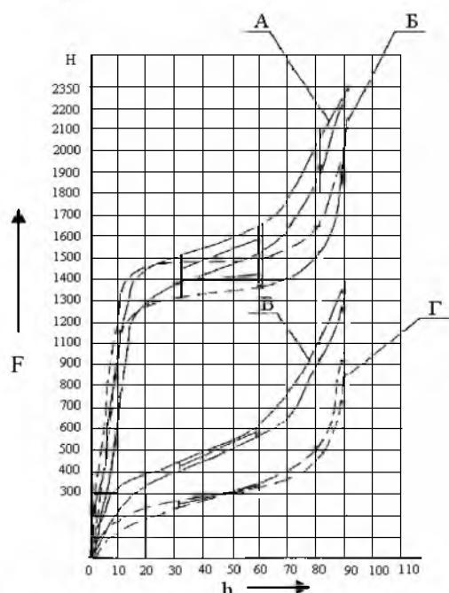
А – сиденье с демпфером отрегулировано на максимальную массу; Б – сиденье без демпфера отрегулировано на максимальную массу; В – сиденье с демпфером отрегулировано на минимальную массу;
