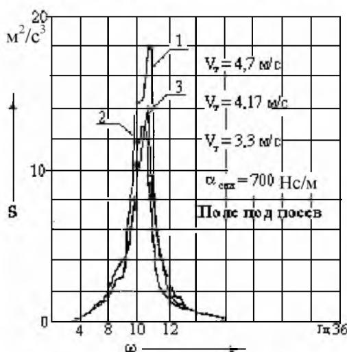
Рисунок 8 – Спектральная плотность ускорений на сиденье
