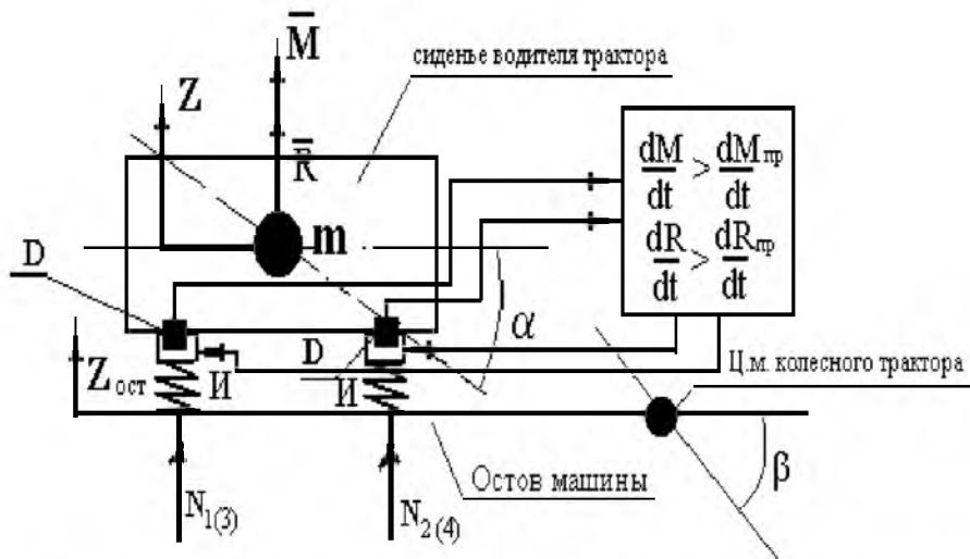
Рисунок 11 – Алгоритм управления АВС на основе анализа сил
