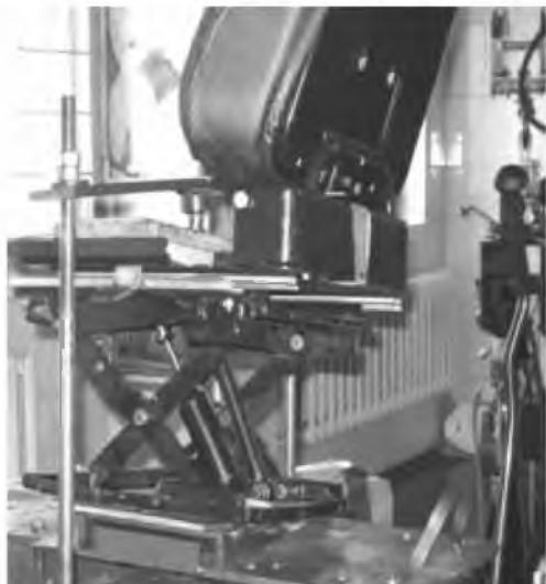
Рисунок 14 – Вибростенд испытаний сиденья 95-6800010
