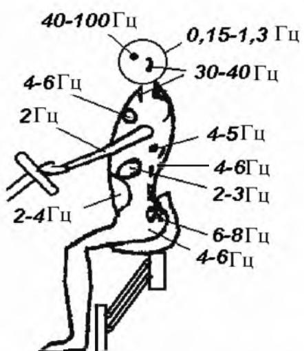
**Рисунок 1 – Распределение частот собственных колебаний по M. Mitschke и F. Deine**
