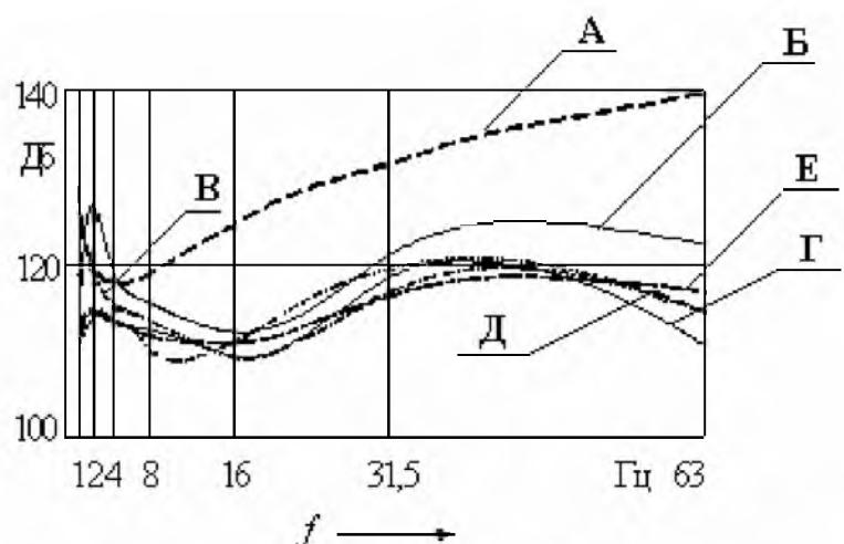
А – допустимое значение вибрации; Б – вибрации на полу кабины;
