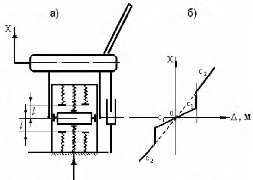
Рисунок 5 – Схема подпрессоривания сиденья водителя с упругими элементами, установленными с зазором (а), и характеристика изменения упругой силы (б)
