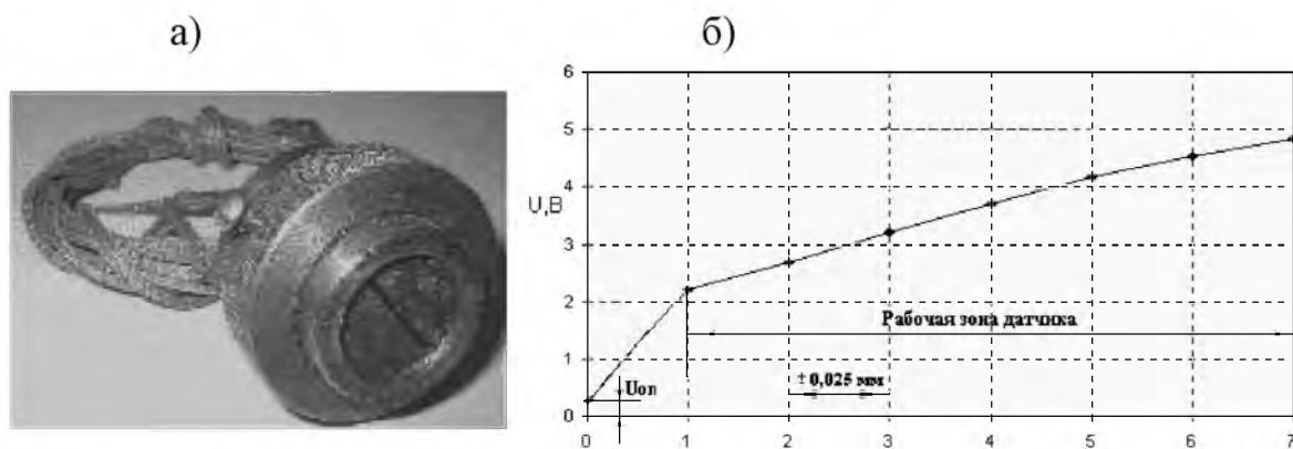
Рисунок 12 – Индукционный датчик сил (а) и характеристика выходного электрического сигнала от датчика (б)
