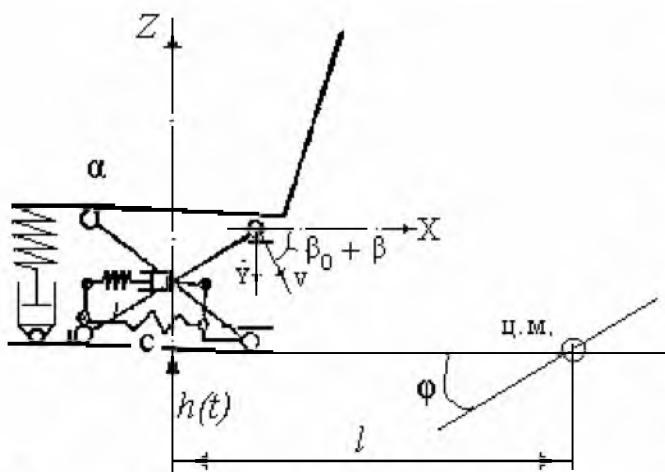
**Рисунок 9 – Модель подвески сиденья с включенным элементом релаксации демпфирования**
