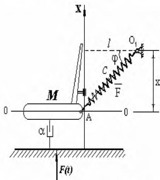
Рисунок 6 – Подвеска сиденья с консольно-закрепленным упругим элементом
