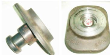
Шкворень полуприцепа седельного автопоезда с фланцем крепления, включающий датчик измерения сил взаимодействия между тягачом и полуприцепом
