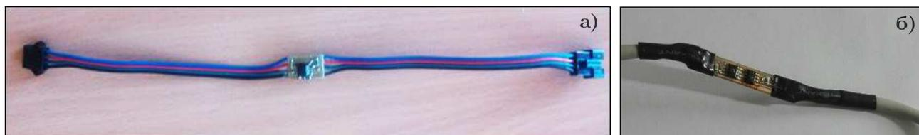
**Рисунок 7 – Внешний вид цифрового датчика влажности для стандартных труб (а) и модифицированного для применения в составе гибких труб (б)**
