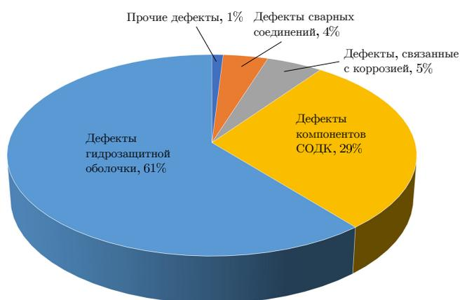
Рисунок 1 – Наиболее распространенные дефекты и повреждения трубопроводов с ППУ-изоляцией
