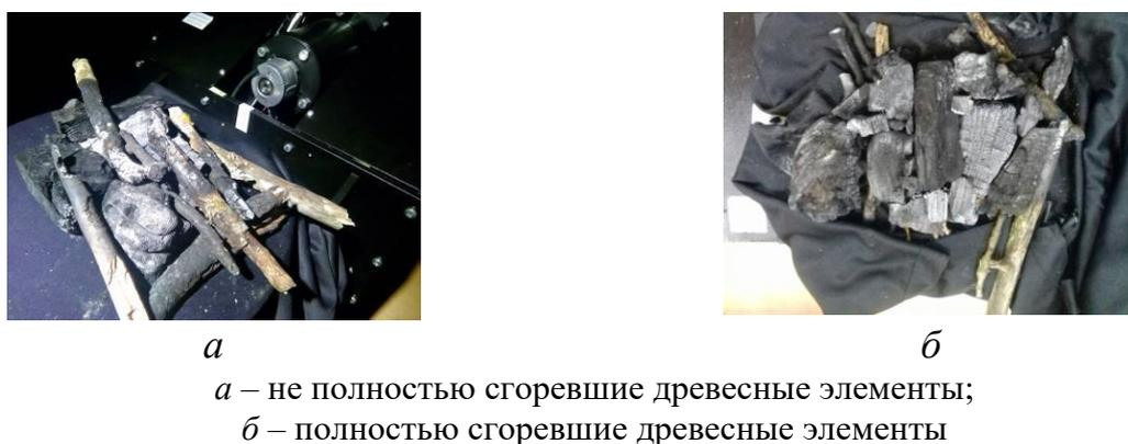
**Рисунок 5 – Фрагменты древесных пород, подвергшихся огневому воздействию**
