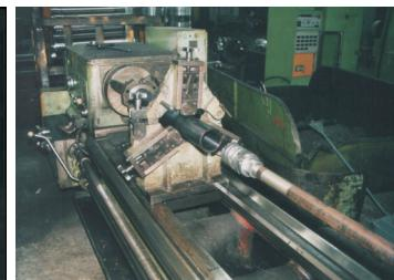
Обработка рабочей поверхности гильз двигателей внутреннего сгорания (ДВС).
