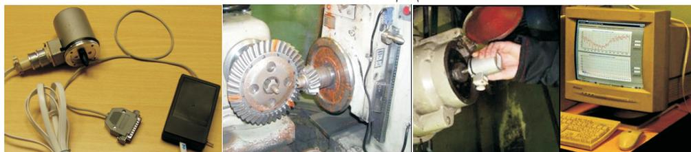
Оперативная оценка кинематической погрешности передачи в сборе и ее частотного спектра, степеней кинематической точности, нормы плавности работы, полноты контакта, наличия и количества локальных дефектов на элементах зацепления и карты визуализации взаимного расположения дефектов колес, величины среднего бокового зазора, верхней границы КПД передачи. Оценка проводится в автоматическом режиме, на основе использования ЭВМ.
