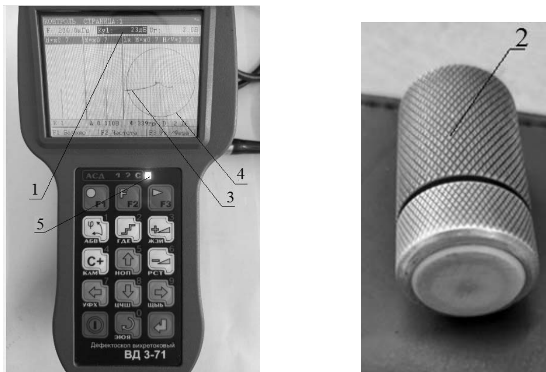
Рис. 9. Установление порога чувствительности дефектоскопа с использованием ВТП с протектором из капролона (усиление дефектоскопа 23 дБ): 1 – усиление дефектоскопа; 2 – ВТП в защитном корпусе с протектором из капролона; 3 – сигнал от ИД5 (глубина 0,2 мм); 4 – пороговый уровень; 5 – индикация автоматической сигнализации дефектов (АСД)
