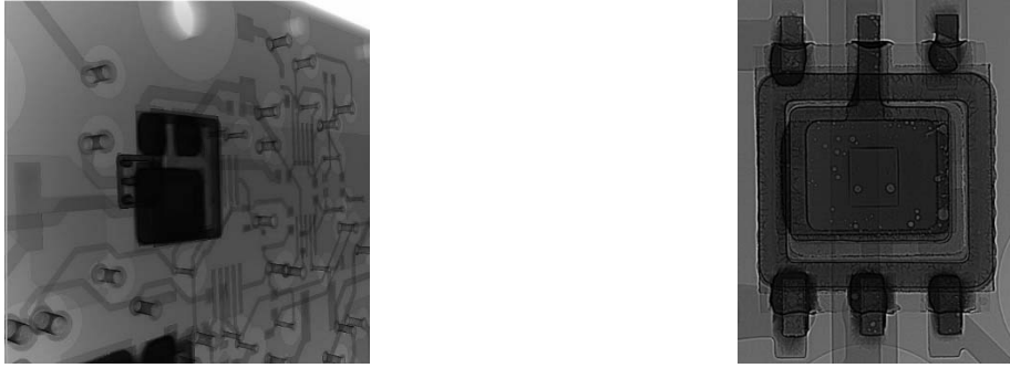
Рис. 2. Рентгеновское изображение фрагментов печатных плат
