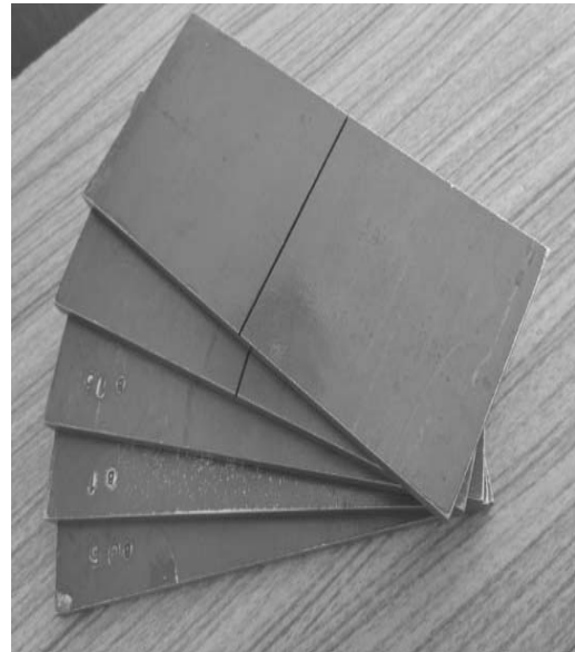
Рис. 2. Плоские образцы толщиной 8 мм с поверхностными надпилами глубиной 0,5; 1; 2 мм
