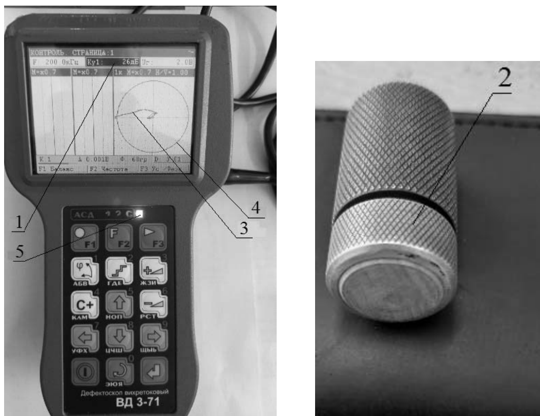
Рис. 10. Установление порога чувствительности дефектоскопа с использованием ВТП с протектором из древесины (усиление дефектоскопа 26 дБ): 1 – усиление дефектоскопа; 2 – ВТП в защитном корпусе с протектором из древесины; 3 – сигнал от ИД5 (глубина 0,2 мм); 4 – пороговый уровень; 5 – индикация автоматической сигнализации дефектов (АСД)
