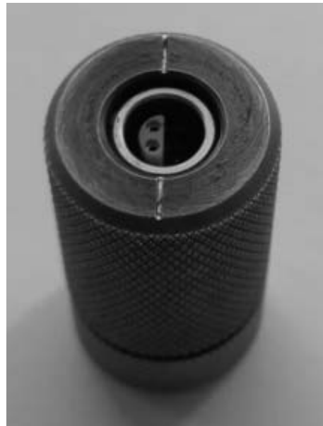
Рис. 3. Расположение ВТП ПН-12-МДФ01 в защитном корпусе
