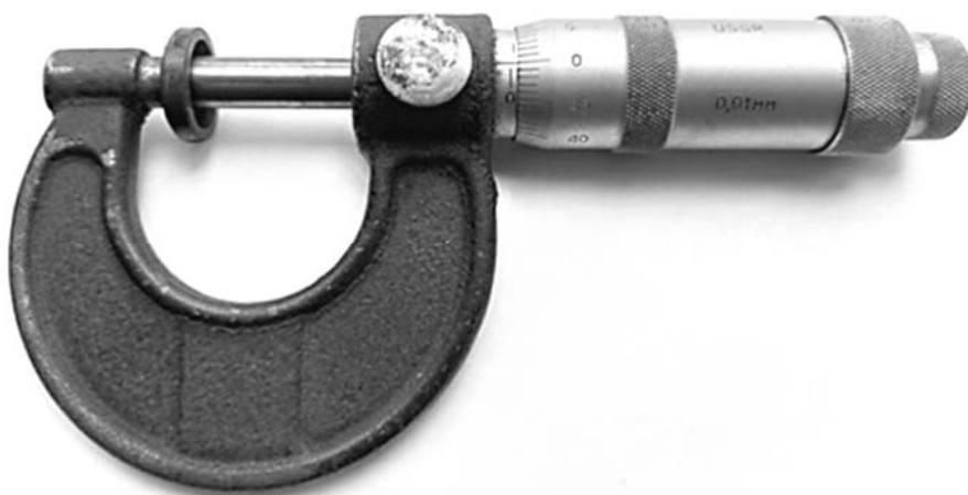
Рис. 6. Измерение толщины керамического протектора микрометром типа МК
