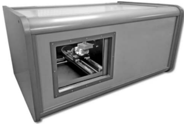
Рис. 3. Микрофокусный рентгеновский компьютерный томограф МРКТ-04
