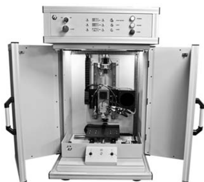
Рис. 5. Специализированная рентгеновская установка ПРДУ «КРОС»
