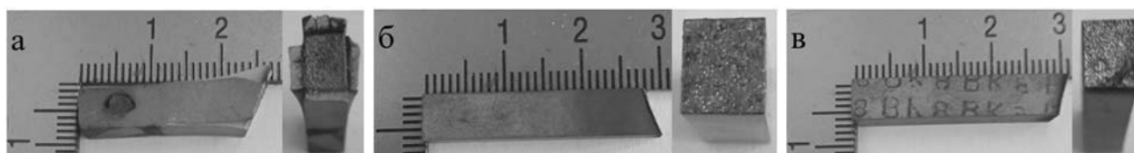
Рис. 2. Внешний вид электродов после легирования: а – без охлаждения; б – с давлением 0,6 МПа; в – с давлением 0,1 МПа
