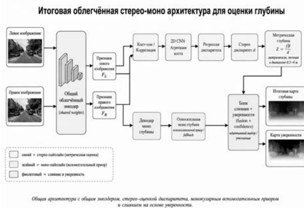
Рис. 1. Итоговая архитектура системы оценки глубины
