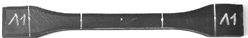
Рис.1. Образец 1В по ГОСТ 11262–2017
