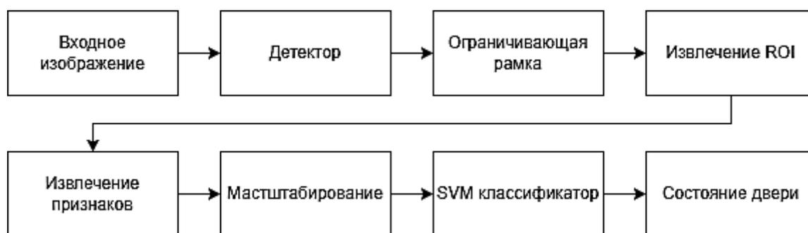
Рис. 1. Архитектура гибридной системы определения состояния двери
