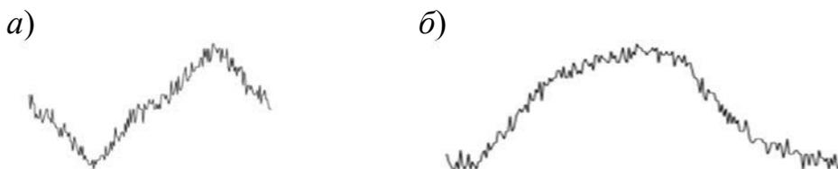
Рис. 1. Примеры изображения графиков нормального состояния трансформатора (а) и с МКЗ (б)
