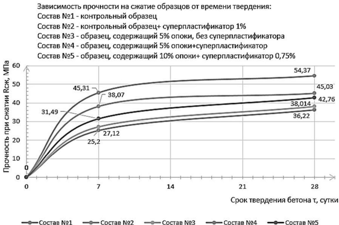
Рис. 2. Зависимость прочности на сжатие образцов от времени твердения
