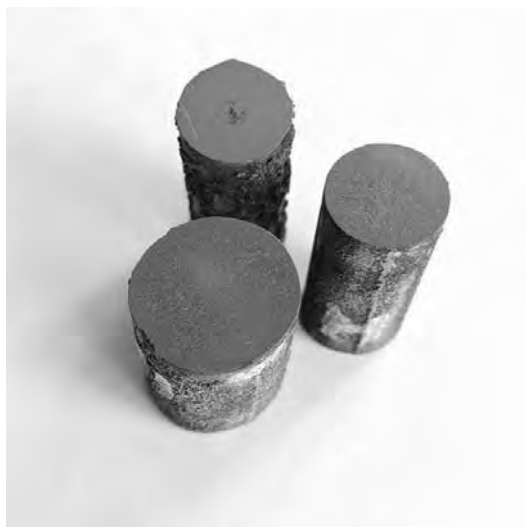
Рис. 1. Подготовленные шлифы для анализа микроструктуры образцов стержней из заэвтектического ИЧХ
