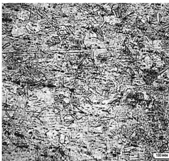
Рис. 2. Микроструктура образцов до и после волочения (×50)
