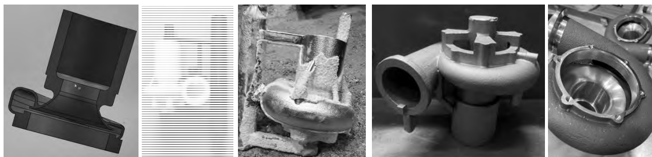
Рис. 3. Этапы изготовления корпуса помпы из сплава АК7пч по выжигаемой модели из РММА-материала
