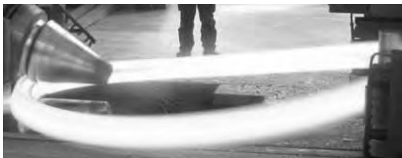
Рис. 1. Образование овальности кольца при кольцераскатке: а – искажение маложесткого кольца; б – зоны контакта кольца в процессе кольцераскатки
