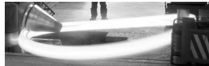
Рис. 1. Процесс кольцераскатки маложесткого кольца
