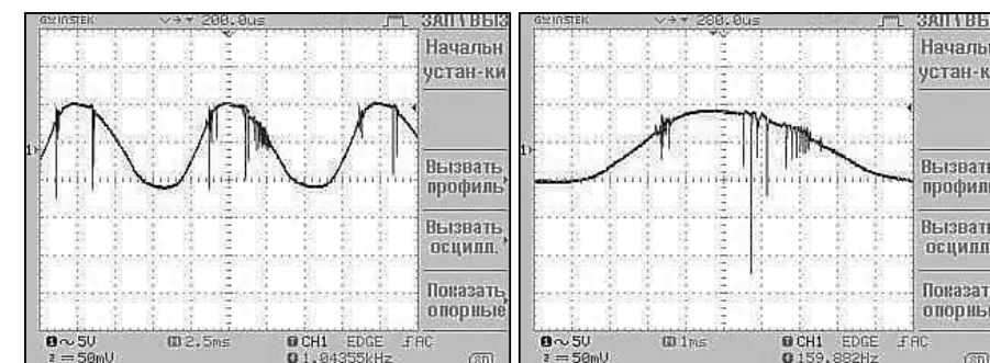
Рис. 2. Осциллограммы тока тлеющего разряда в процессе упрочнения
