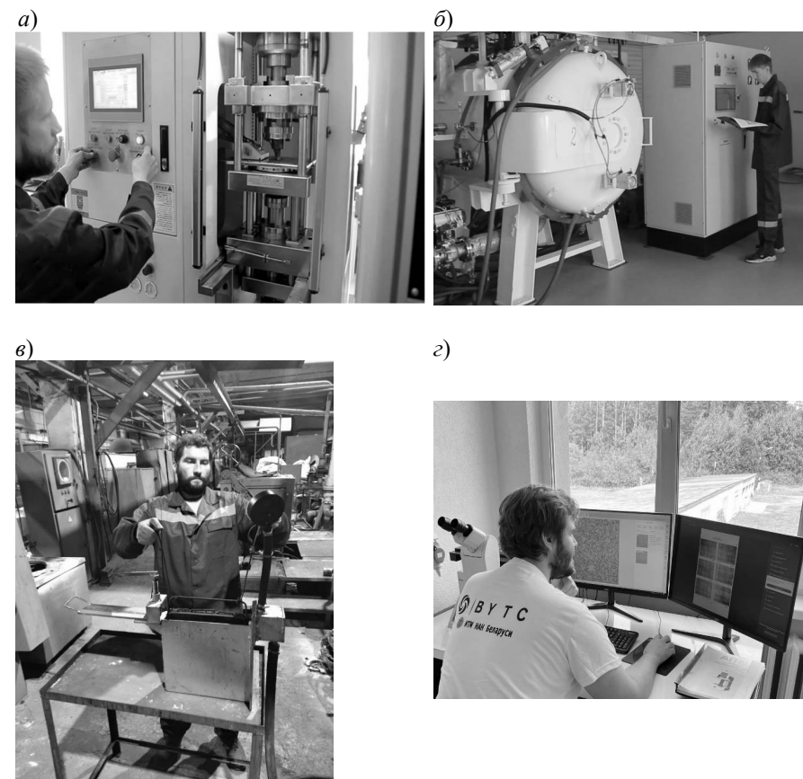
Рис. 2. Отдельные этапы инновационной технологии производства твердосплавных пластин, созданной на базе ИТМ НАН Беларуси: а – прессование; б – спекание; в – упрочнение; г – контроль качества
