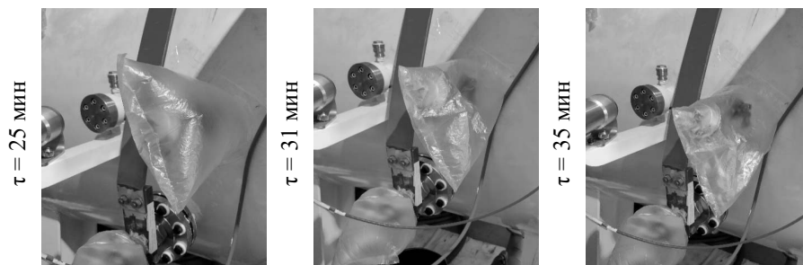
Рис. 2. Динамика изменения объема воздуха внутри герметизирующей оболочки
