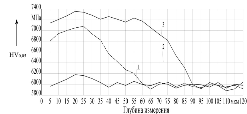
Рис. 3. Микротвердость поверхностного слоя образцов из стали 4Х4ВМФС: 1 – микротвердость поверхностного слоя образцов до обработки; 2 – после обработки тлеющим разрядом с оптимальными параметрами; 3 – после обработки тлеющим разрядом с прикатодным магнитным полем с оптимальными параметрами
