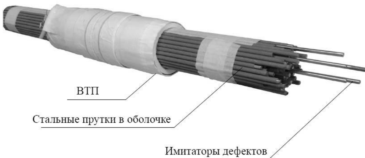
Рис. 3. Испытательный стенд (масштабная модель стренового каната, масштабная модель ВТП, имитаторы дефектов)
