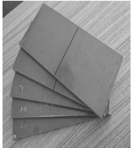
Рис. 2. Плоские образцы толщиной 8 мм с поверхностными надпилами глубиной 0,5; 1; 2 мм
