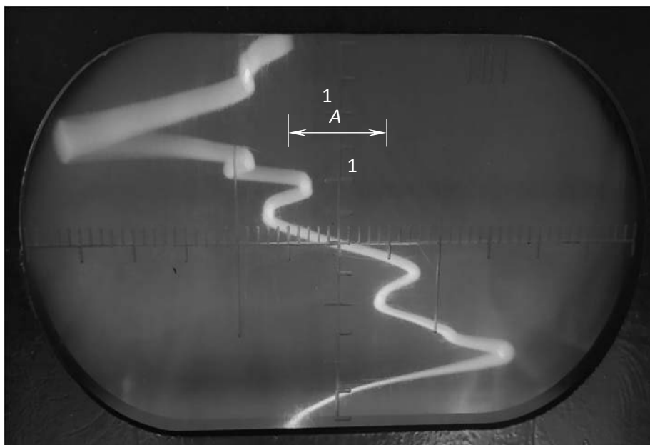
Рис. 5. Вид сигналограммы при магнитографическом контроле сварного соединения с выпуклостью обратной стороны шва (с полным проплавлением)
