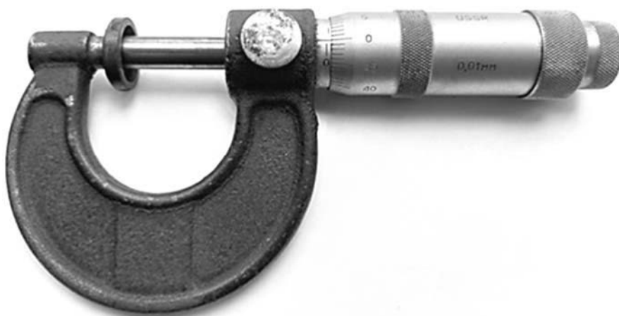
Рис. 6. Измерение толщины керамического протектора микрометром типа МК
