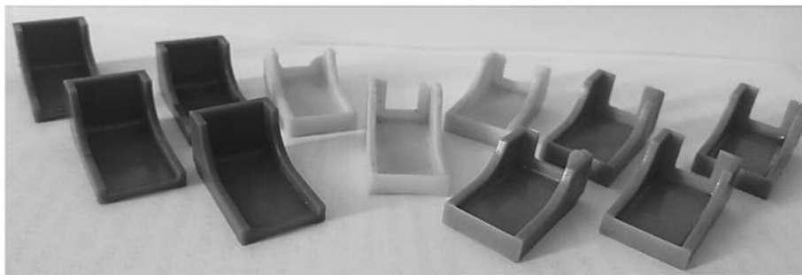
Рис. 1. Протекторы из различных материалов с кривизной контактных поверхностей 98, 102, 108, 159 мм
