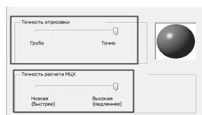
Рис. 2. Настройки точности отрисовки в программе КОМПАС-3D
