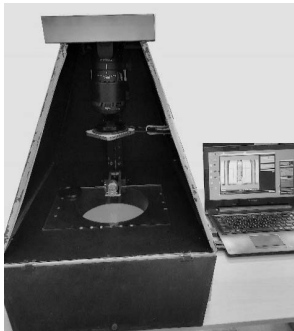
Рис. 1. Установка для контроля распределения напряжений в изделии из стекла
