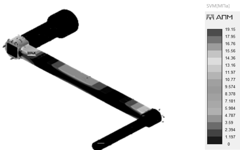
Рис. 3. Результаты прочностного расчета солнечного колеса с ручкой на напряжении в программе КОМПАС-3D
