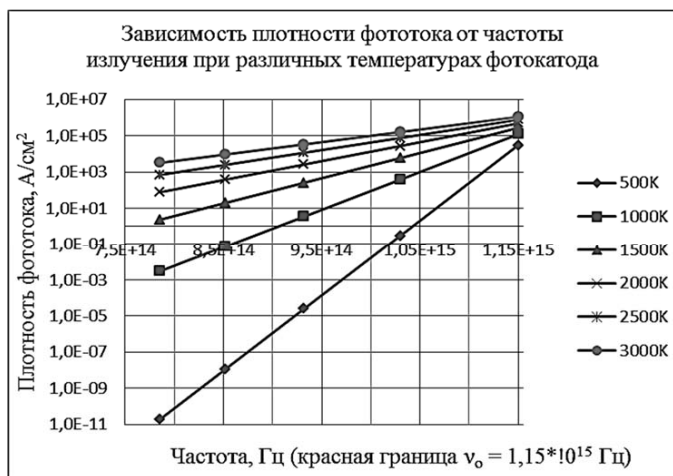
Рис. 1. Зависимости плотности фототока от частоты при различных температурах
