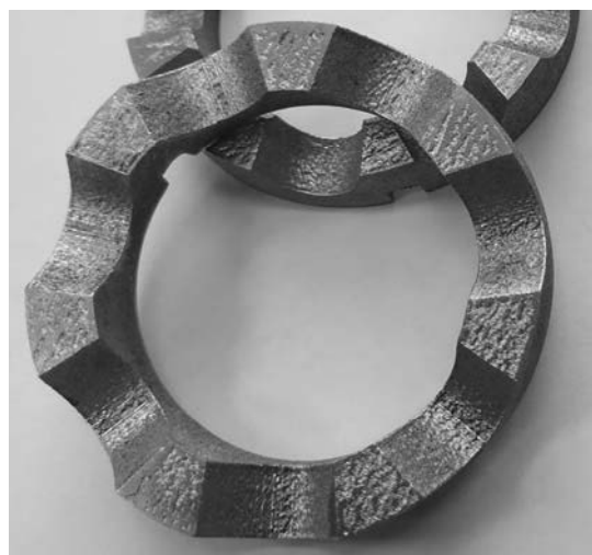
Рис. 1. Центральное колесо СРП: а – модель, разработанная в NX; б – изготовленные образцы колес
