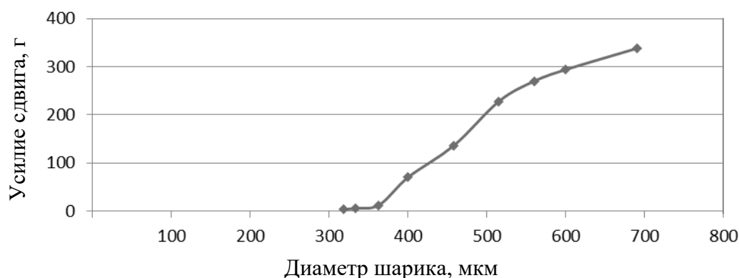
Рис. 2. Зависимость усилия сдвига шариков припоя от их диаметра
