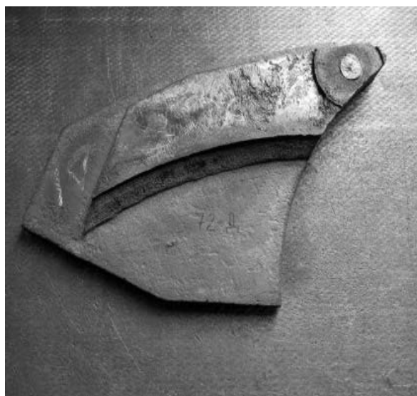
Рис. 1. Экспериментальная деталь «Лист подкладной УЗ.1,1», изготовленная с применением дробы
