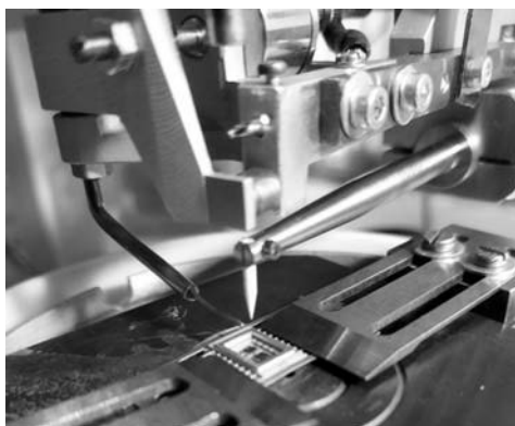
Рис. 1. Сварочная головка установки ЭМ-6705М присоединения выводов методом «шарик – клин»
