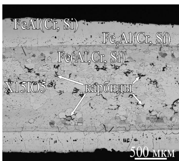
Рис. 2. Структура покрытия на сплаве X15Ю5 после термообработки 1100 °С, 20 ч (а) и распределение химических элементов по толщине покрытия (б)
