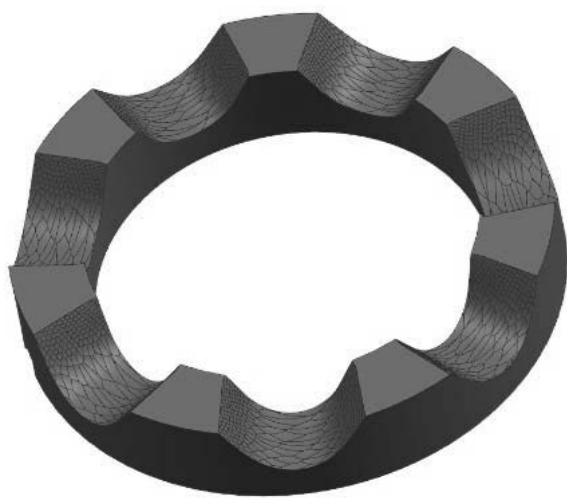
Рис. 1. Центральное колесо СРП: а – модель, разработанная в NX; б – изготовленные образцы колес
