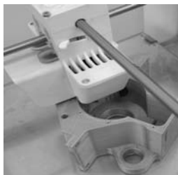
Рис. 3. Печать кривошипно-шатунного корпуса
