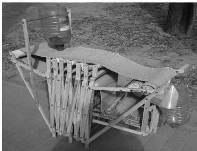
Рис. 1. Телескопический конвейер в сложенном положении
