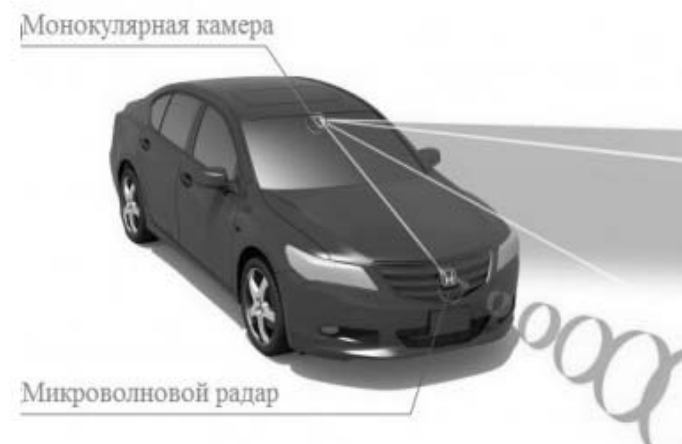
Рис. 2. Расположение приборов технического зрения на автомобиле
