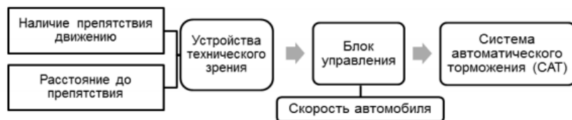
Рис. 1. Структурная схема автоматической системы экстренного торможения
