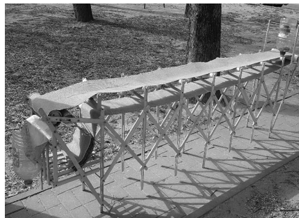
Рис. 2. Телескопический конвейер в растянутом положении
