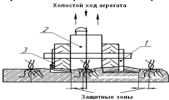
Рис. 1. Схема конструкции мини-агрегата: 1 – стрельчатая лапа; 2 – мотоблок «Зубр»; 3 – лапа «бритва»
