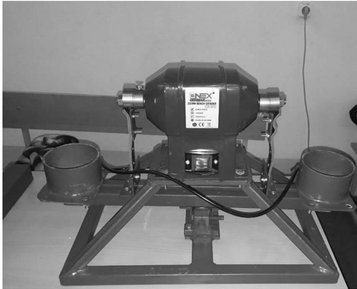
Рис. 2. Опытный образец балансирующей вибродисковой мельницы
