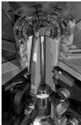
Рис. 1. Конструкция экспандера для исправления геометрической формы кольца
