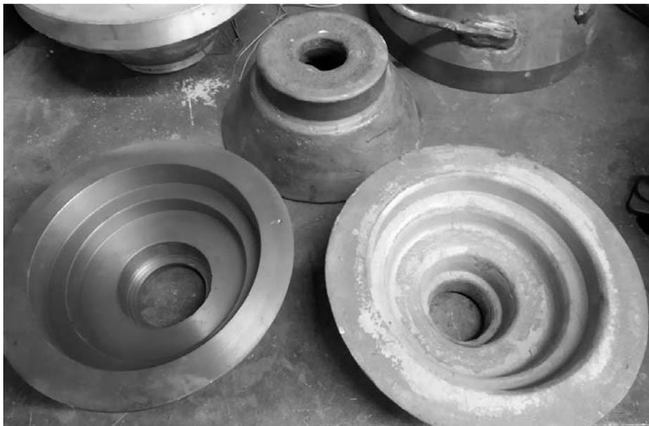
Рис. 2. Отливка корпуса редуктора
