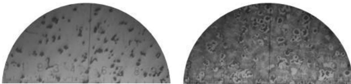
Рис. 1. Исходная структура отливок из низколегированного высокопрочного чугуна
