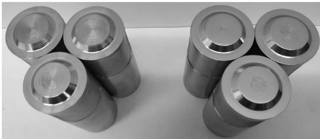
Рис. 1. Матрицы: слева – проточенные; справа – шлифованные
