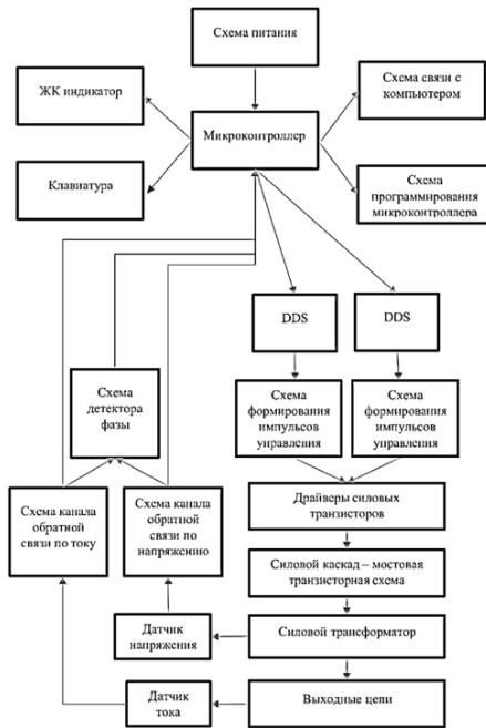
Рис. 1. Функциональная схема генератора
