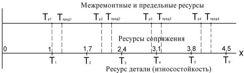
Рис. 1. Схема зависимости между ресурсом упрочненной детали – ресурсом сопряжения – межремонтным ресурсом машины: T_{p1}, T_{p2}, \dots, T_{pi} – межремонтные ресурсы машины; T_{пред1}, T_{пред2}, \dots, T_{предi} – предельные ресурсы машины; T_1, T_2, \dots, T_i – ресурсы восстановленной машины
