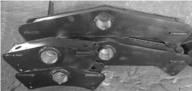
Рис. 1. Балансиры ходовой системы полуприцепов МАЗ в сборе с втулками из антифрикционного силумина
