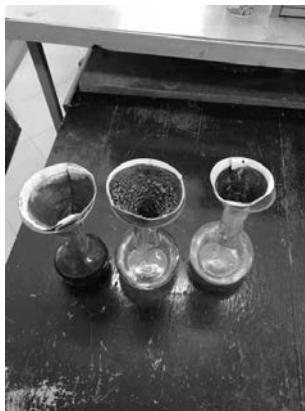
Рис. 1. Приготовленная суспензия графита (а) и образцы высушенных суспензий графита после УЗО (б)
