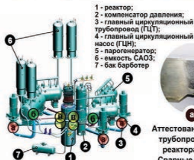
Схема реакторной энергетической установки ВВЭР
