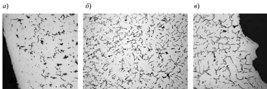
Рис. 1. Различия в графитовых включениях по толщине стенки ( \times 100 ): а – наружная зона отливки; б – средняя; в – внутренняя поверхность
