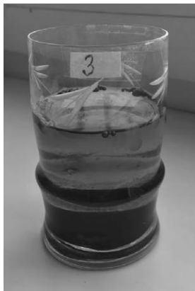
Рис. 1. Приготовленная суспензия графита (а) и образцы высушенных суспензий графита после УЗО (б)
