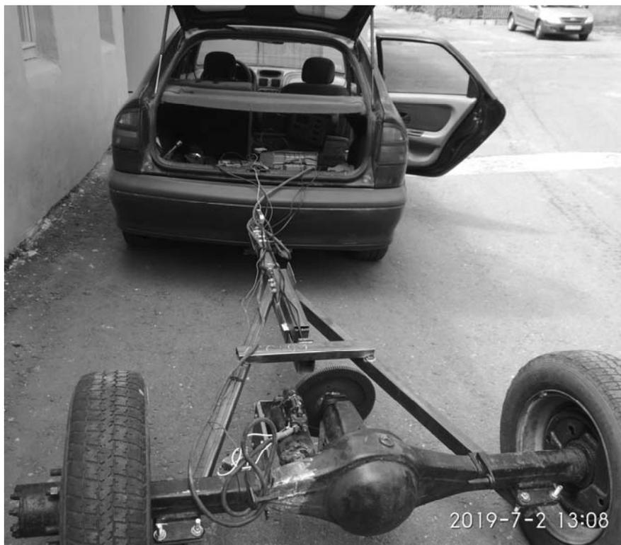
Рис. 6. Ходовые испытания алгоритма превентивной передачи момента колесам экспериментальной тележки с электромеханическим приводом
