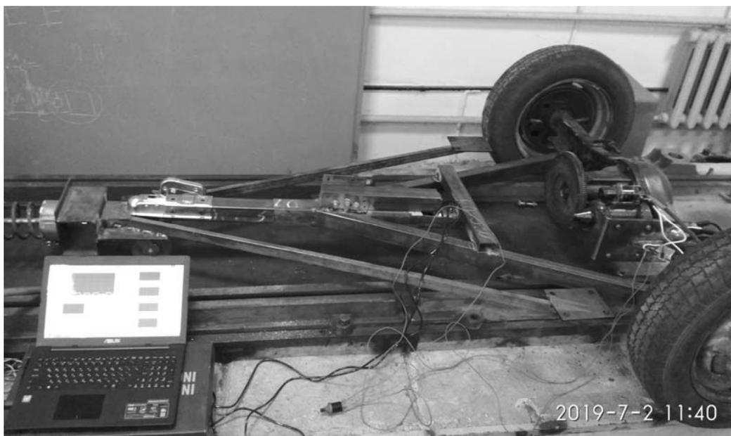
Рис. 5. Стенд для исследования алгоритма превентивной передачи момента колесам тележки с электромеханическим приводом ее колес
