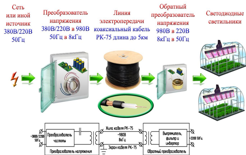
Рис. 1. Резонансная система электропитания для облучения растений
