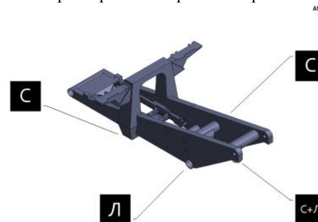
Рис. 4. Цифровой прототип рамы к/с БелАЗ 75320: С – сварные детали и узлы; Л – литые детали и узлы
