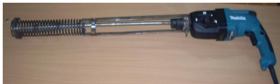
Рис. 15. Виброуплотнитель на базе электрического перфоратора
