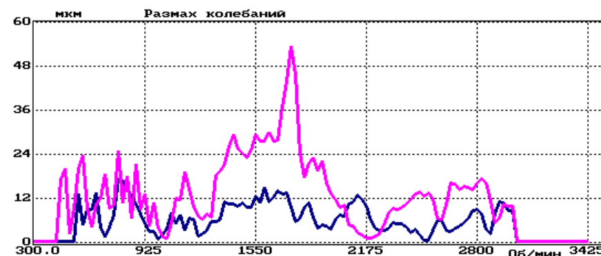
Рис. 2. Вибрационные характеристики выбега с большими отличиями
