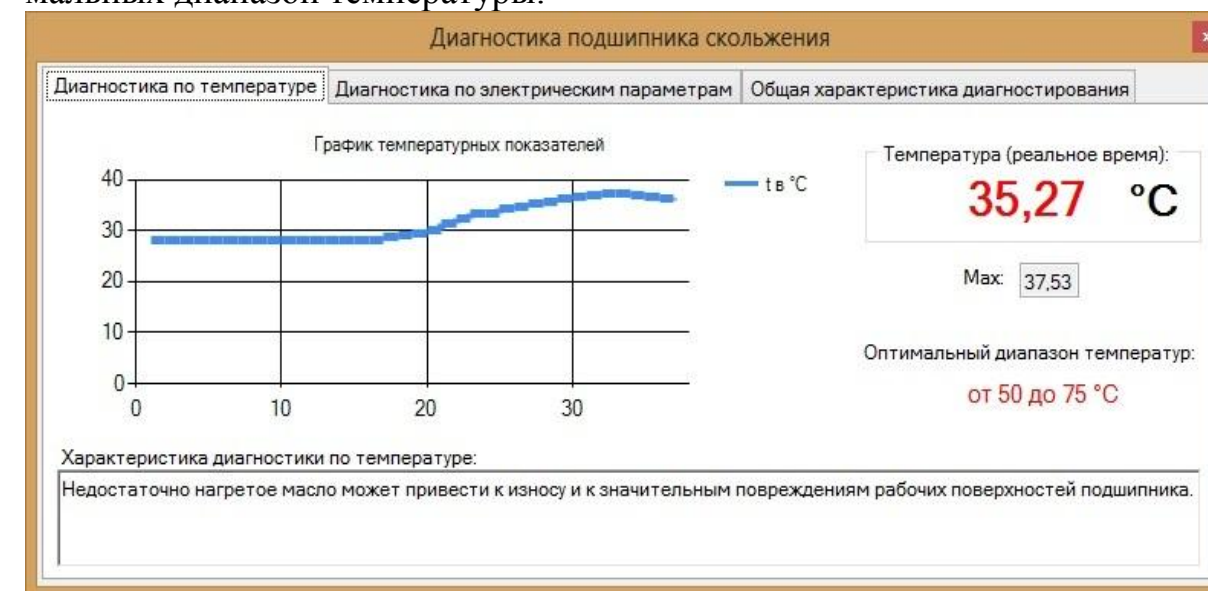
Рис. 1. Диагностика подшипника скольжения по температуре
