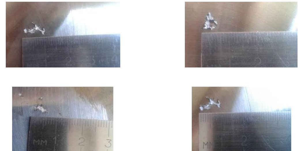
Рис. 2. Шлаковые включения в стальной отливке после вскрытия
