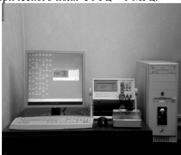
Рис. 1. Малогабаритная установка для контроля комплекса диэлектрических показателей пластинчатых изоляционных материалов электротехнического назначения в диапазоне частот 50 Гц–1 МГц
