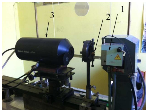
Рис. 1. Установка для определения размеров фокусного пятна рентгеновской трубки
