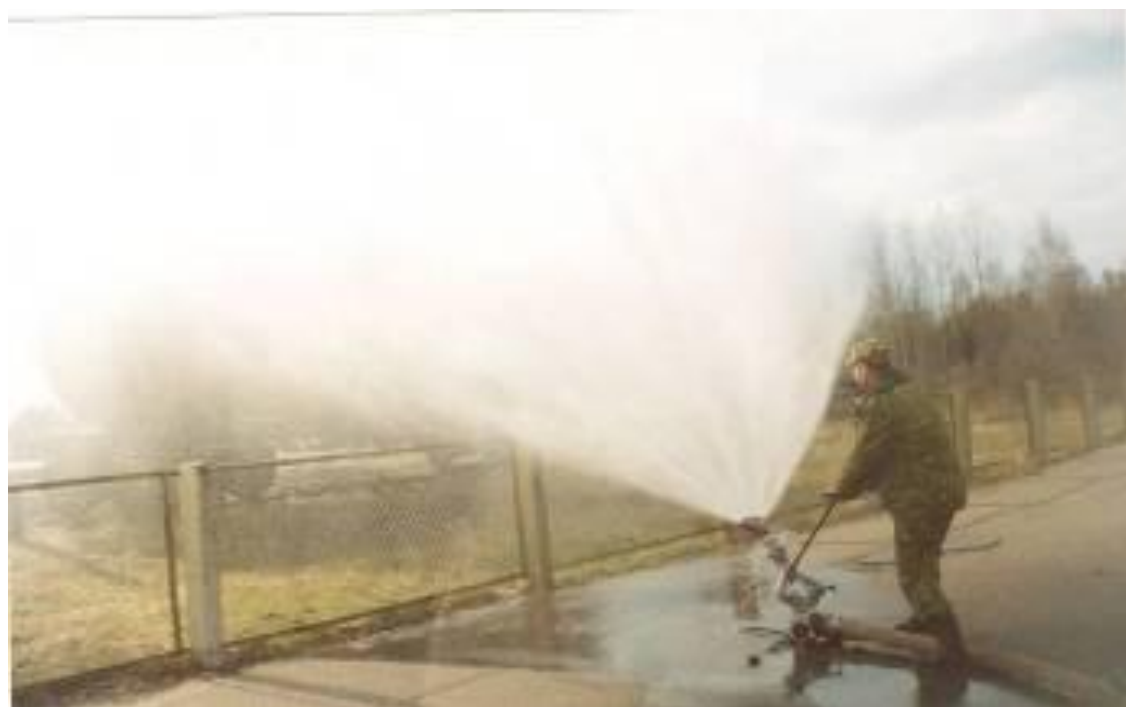
Рис. 2. Испытания устройства для распыления струи воды с регулировочной вставкой
