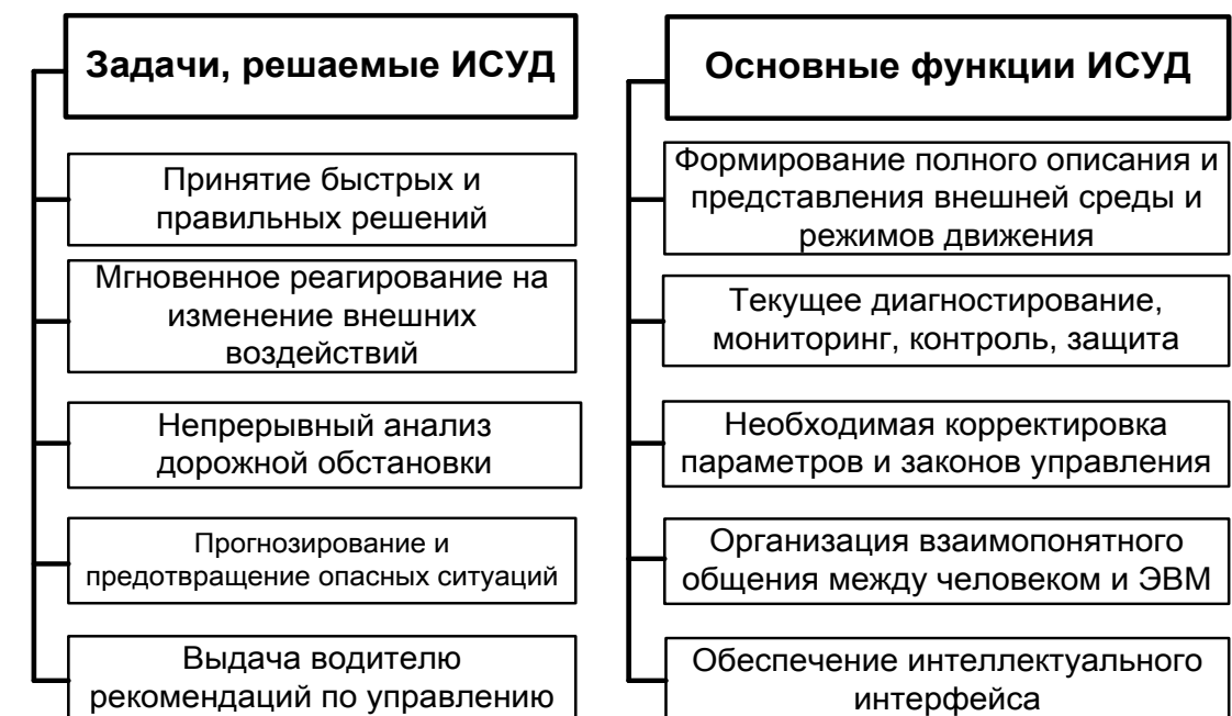
Рис. 1. Идеология автоматизации управления и диагностирования на основе создания интеллектуальных систем класса ИСУД
