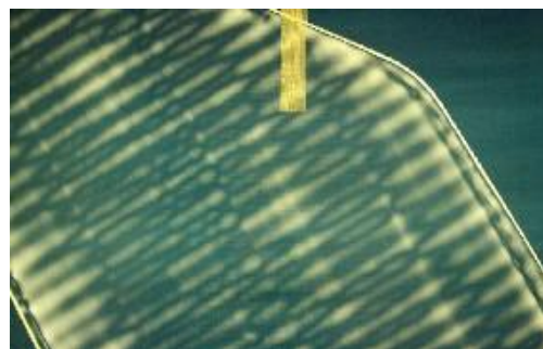
Рис. 2. Регистрируемое распределение интенсивности света, прошедшего через контролируемое автомобильное стекло
