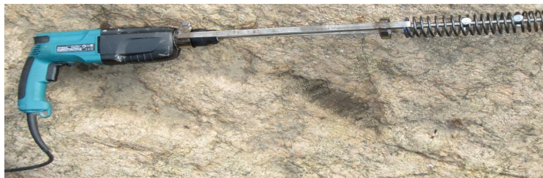
Рис. 2. Экспериментальный пружинный виброуплотнитель
