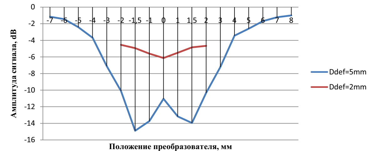
Рис. 3. Зависимость амплитуды сигнала от размера преобразователя
