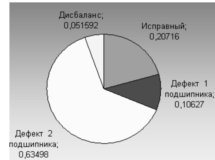
Рис. 2. Значения функции принадлежности к 4-м классам технического состояния объекта № 55
