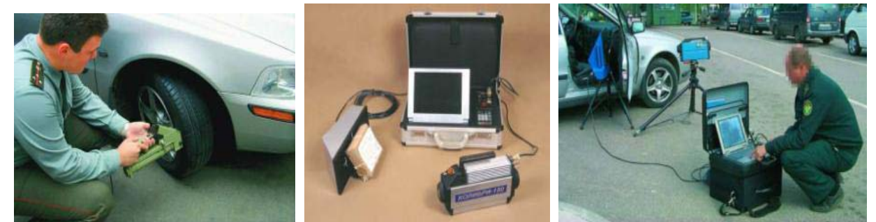
Рис. 14. Рентгеновский сканер скрытых полостей «Ватсон», переносные рентгенотелевизионные комплексы "Колибри 150 ТВ" и "Шмель 240 ТВ"
