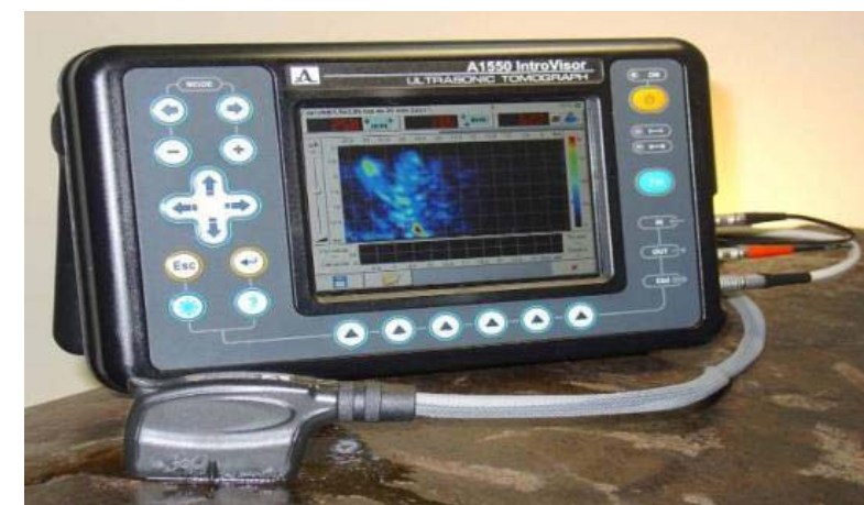
Рис. 3. Ультразвуковой томограф A1550 IntroVisor
