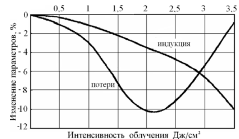
Рис. 1. Зависимость магнитных потерь P_{1,7/50} и индукции B_{100} в стали от ЛЛО
