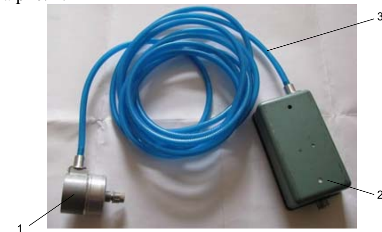
Рис. 2. Многоэлементный волоконно-оптический датчик избыточного давления с вынесенным преобразователем: 1 – первичный преобразователь; 2 – блок усиления и преобразования сигнала; 3 – волоконно-оптический кабель
