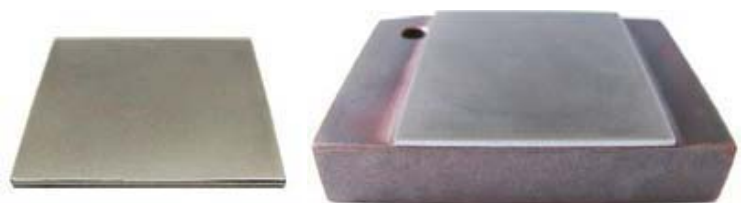
Рис. 3. Меры толщины никелевых покрытий МТ-НП (сверху) и МТОНП (снизу)
