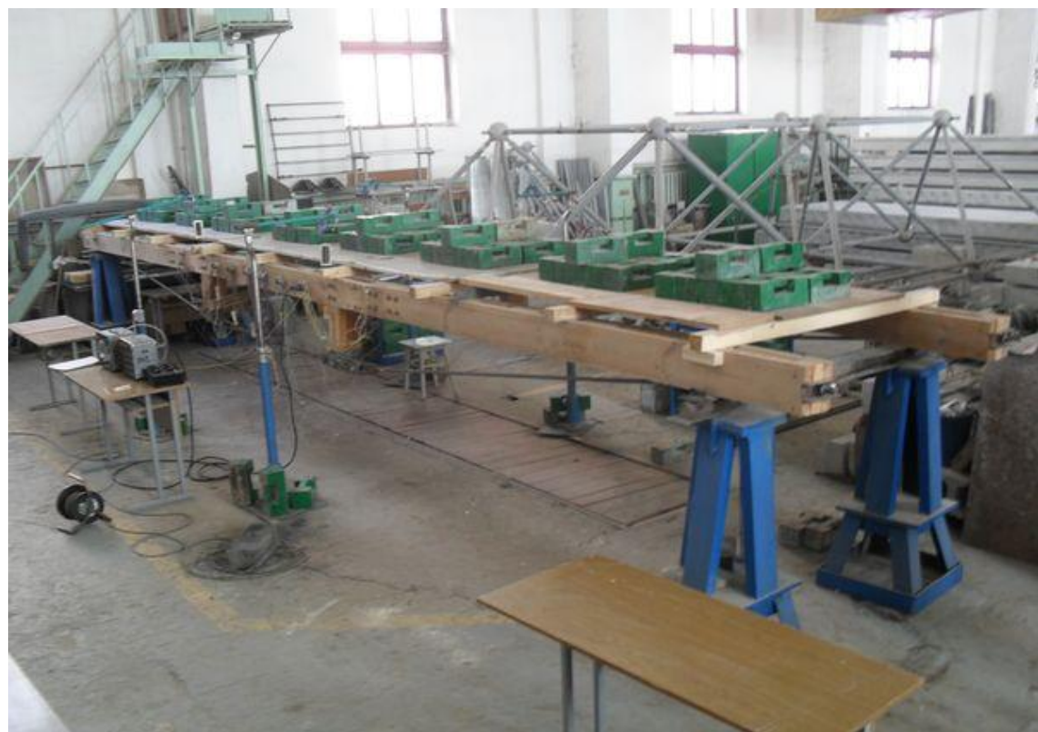
Рис. 1. Блок из двух металлодеревянных ферм на испытаниях
