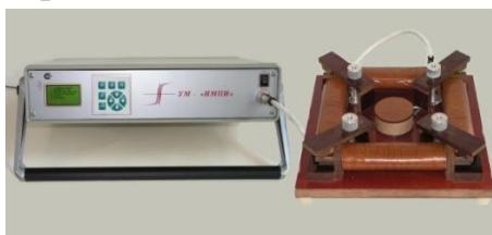
Рис. 1. Установка магнитоизмерительная для испытания электротехнической стали
