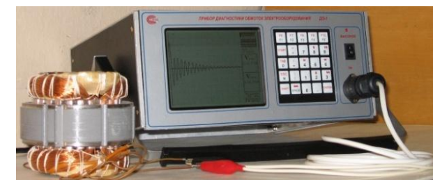
Рис. 1. Прибор ДО-1 для испытания обмоток электротехнического оборудования
