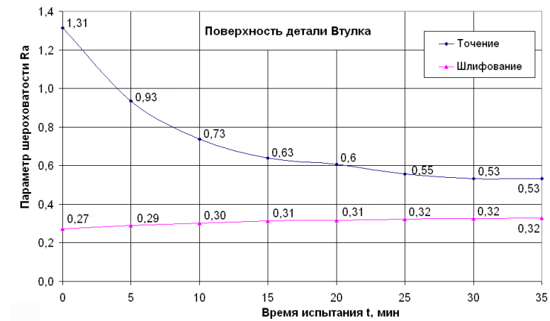
Рис. 1. Изменения параметра среднего арифметического отклонения профиля R_a поверхности детали втулка в процессе приработки
