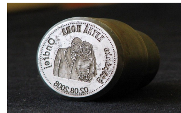
Рис. 2. Пуансон с рельефом
