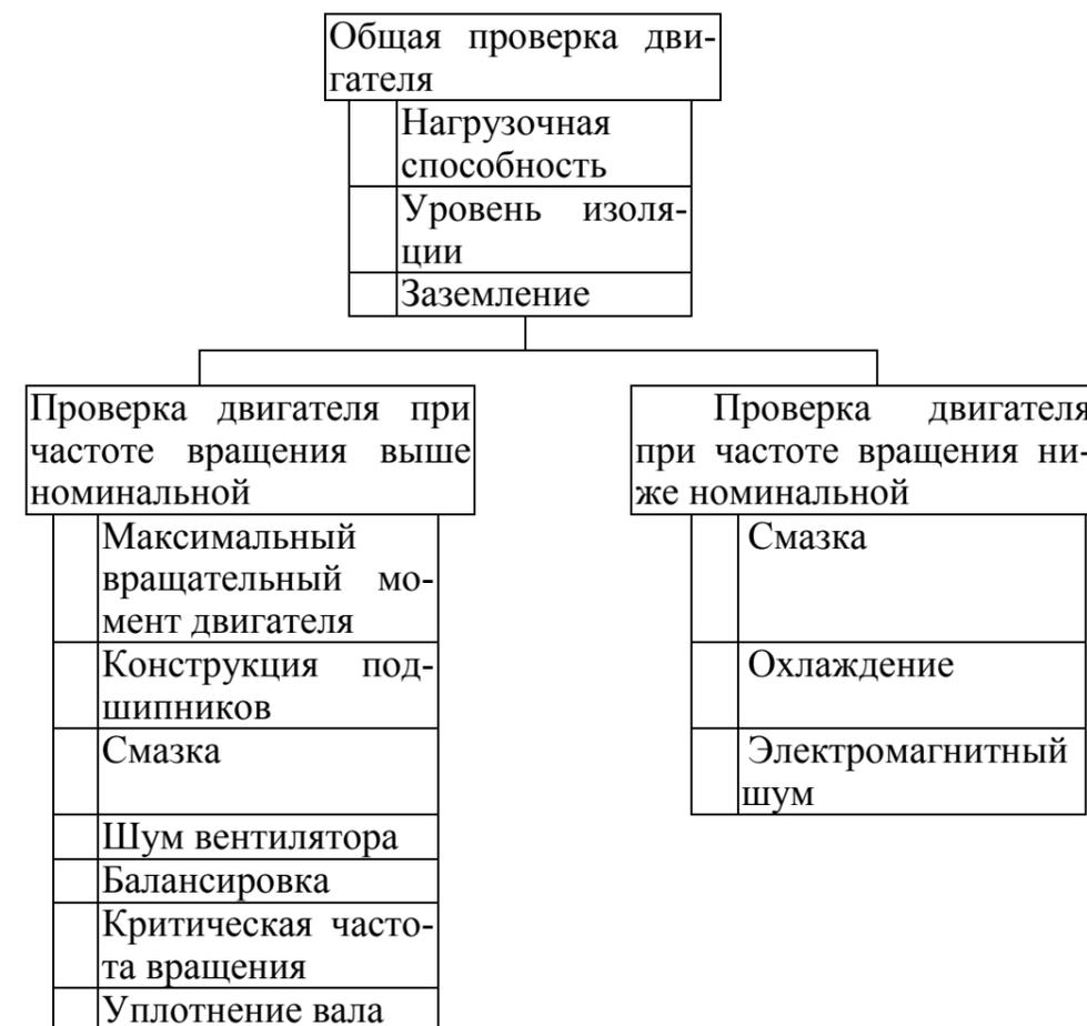
Рис. 3. Схема проверок двигателя при управлении от преобразователя частоты
