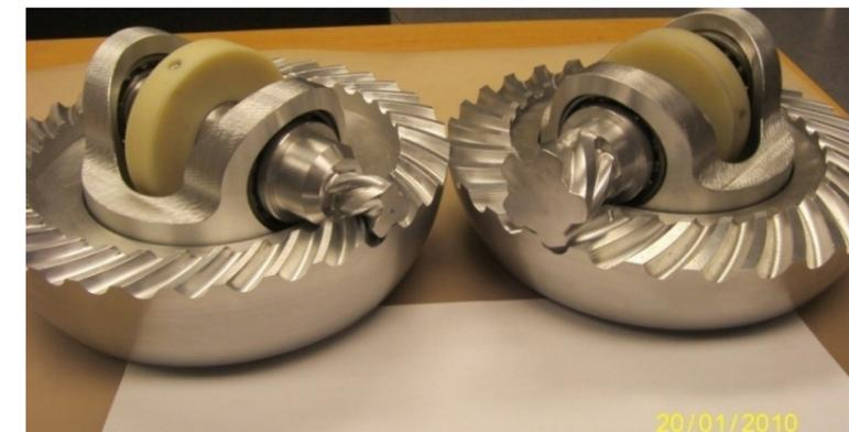
Рис. 2. Макеты конических редукторов с ExSyGear зацеплением
