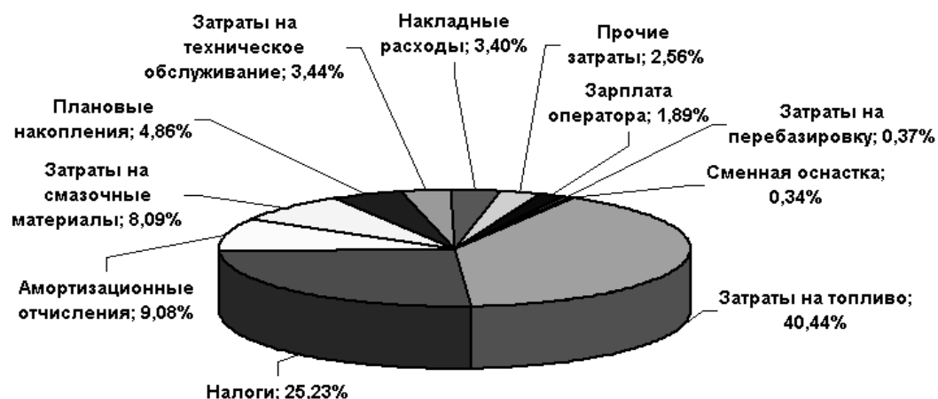
Рис. 1. Составляющие стоимости машино-часа работы погрузчика Амкодор 333 (ТО-18Б)
