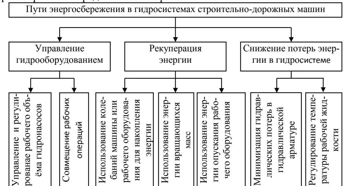
Рис. 2. Пути энергосбережения в гидросистемах строительно-дорожных машин
