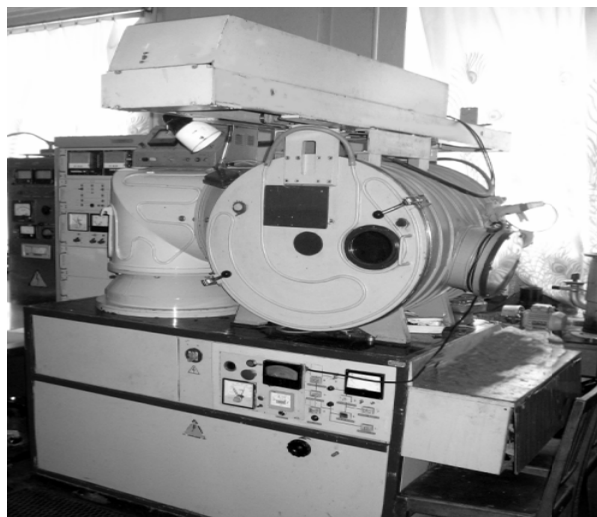
Рис. 1. Общий вид вакуумной установки для модификации двухкарбидных твердосплавных пластин в тлеющем разряде
