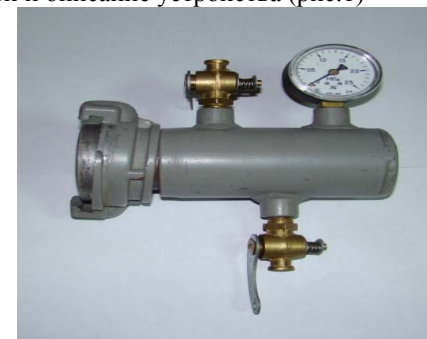
Рис. 1. Устройство для контроля пожарных кранов на водоотдачу
