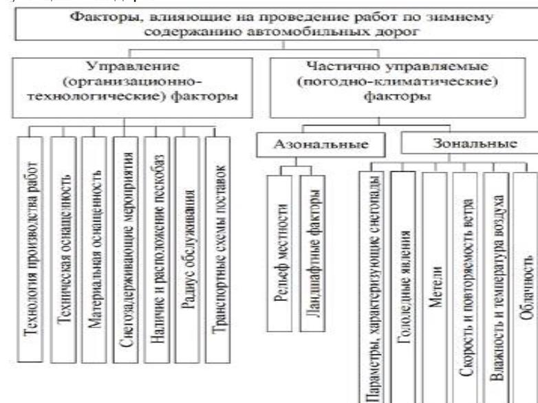
Рис 1. Схема взаимодействия факторов, влияющих на условия производства работ по содержанию автомобильных дорог в зимний период
