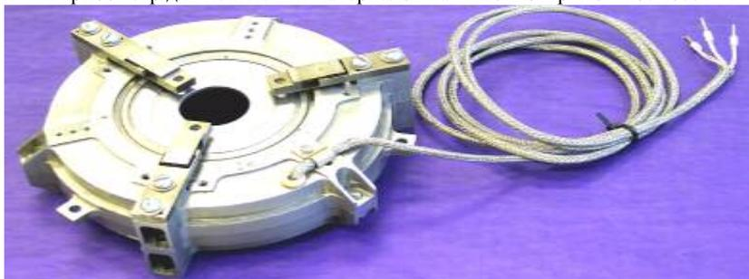
Рис. 10. Трибометр с сервоприводом для МКС и его компоненты
