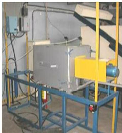
Установка для нанесения полимерного покрытия на фланцы
